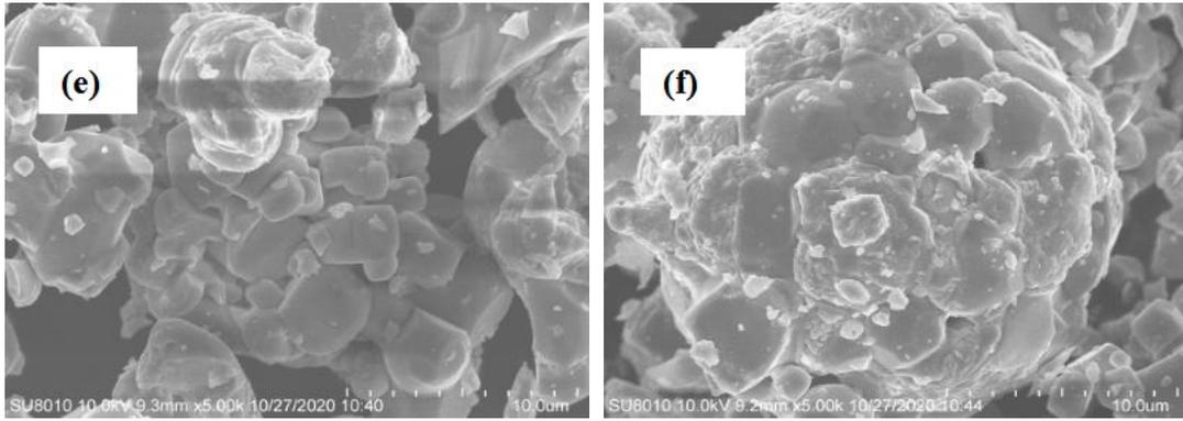
Fig. 4. SEM images of doped LNMOs; (a) A- LNMO; (b) A-LNMNO1; (c) A-LNMNO2; (d) A-LNMNO3; (e) A-LNMNO4; (f) A-LNMNO5
